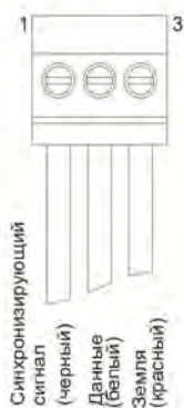
Провода присоединительного кабеля
